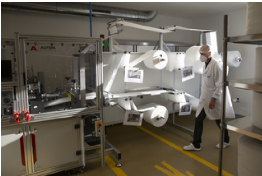
La chaîne de production débute par l'assemblage de 4 couches de textile. | Keystone / Salvatore Di Nolfi Keystone / Salvatore Di Nolfi
